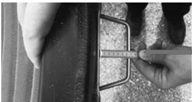
Stålbøyle/støtte bak sulkisetet får stikke ut maksimalt 60 mm.
